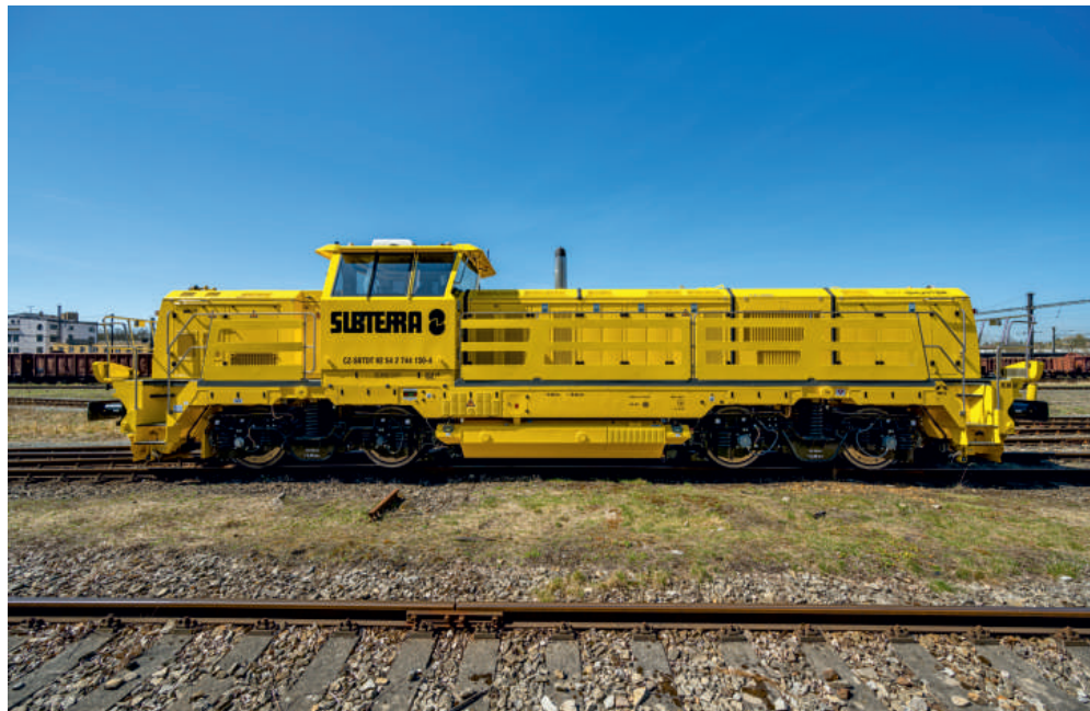
Lokomotiva EffiShunter 1000 je vrcholným typem vyvinutým společností CZ LOKO. Délka přes nárazníky činí 16,4 metru, jmenovitá hmotnost 80 tun.
