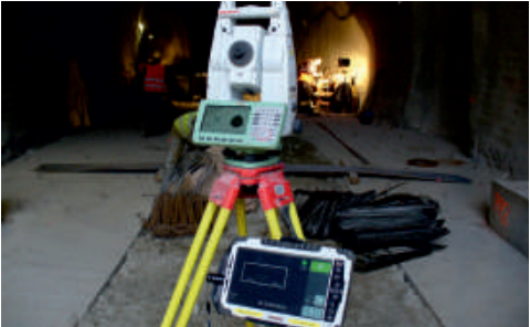
Přístrojovým základem systému Navigator je totální geodetická stanice spojená s tabletem.
