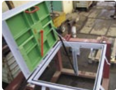
Poklopy D 400 s otvíráním pomocí pistu pocházejí ze zbraslavských dílen
